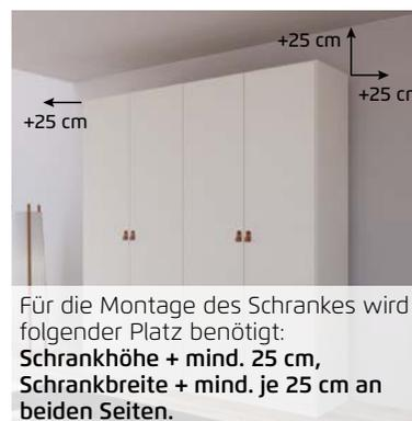
Für die Montage des Schrankes wird
